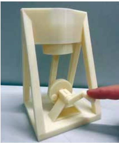
Beispielbauteil zur Untersuchung der notwendigen Spaltmaße
