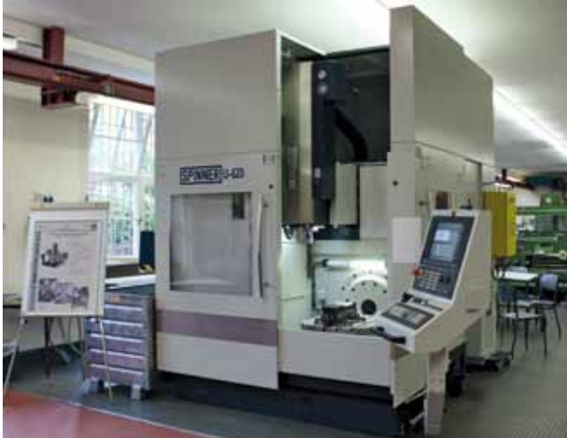
5-Achsen-Bearbeitungszentrum SPINNER U-620
