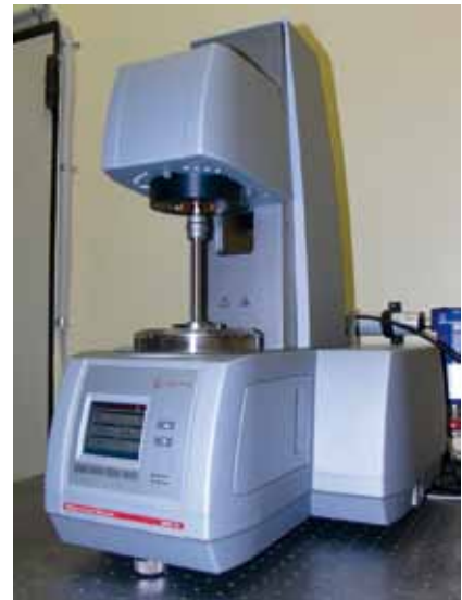
Rheometer der neuesten Generation zur Untersuchung der rheologischen Eigenschaften von Schmierstoffen über einen weiten Temperaturbereich
