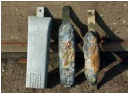
Verbrauchte Zink-Anoden im Vergleich mit einer neuen (links)
