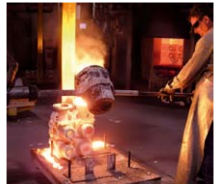
©Zollern GmbH & Co.KG - offener Stahl-Feinguss
