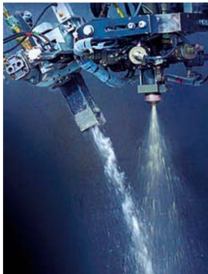
Prototyp eines PUR-Sprühkopfes mit Faserzudosierung (von links) (Quelle: Bayer MaterialScience AG)
