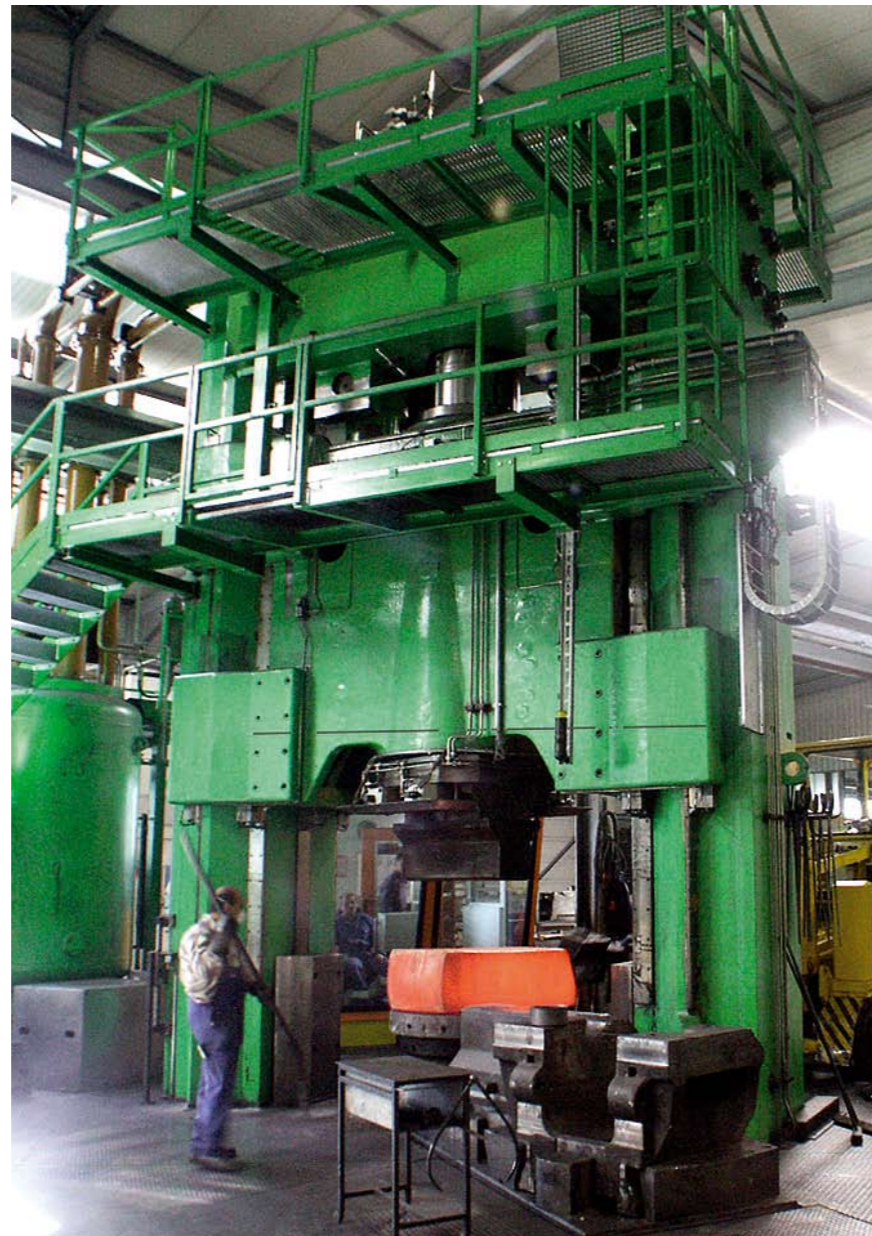
Freiformschmieden mittels hydraulischer 1600 t-Schmiedepresse
