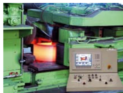
Walzen eines Kupferringes im Ringwalzwerk
