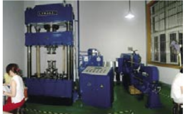
Blick auf die 300 Mp Presse und die Kreisschere zum Ausschneiden der Rondeln (rechts)
