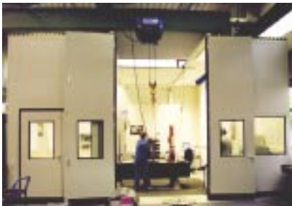
Messraum nach VDI/VDE 2627 mit 3D-Koordinaten-Messmaschine inkl. Möglichkeit der Hallenkran-Bedienung durch öffnungsfähige Decke
