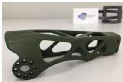
Bionisch optimierter Roboterarm (www.poppy-project.org)
