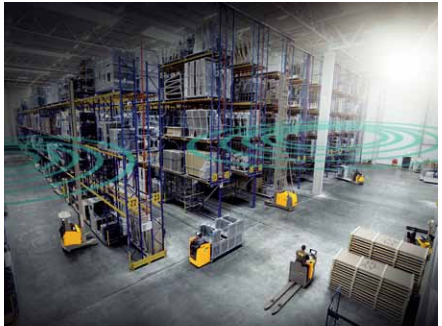
Jungheinrich Indoor Ortung zur einfachen Lokalisierung von Flurförderzeugen innerhalb des Lagers
