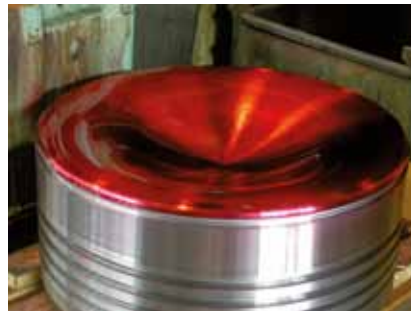
Kolbenboden während der Rissprüfung
