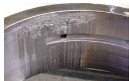
Lagerschaden an einem Pleuel
