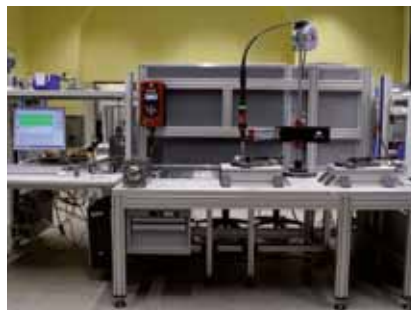
Prüfstand mit EC-Schraubspindel zur Aufnahme von Drehmomentsignaturen
