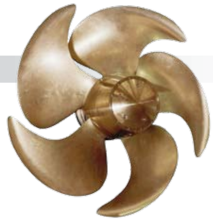
Schiffspropeller mit verstellbaren Blättern. Gewicht der Nabe ca. 3000 kg. Blattgewicht ca. 1500 kg/Stück. Werkstoff EBG=CuAl10Fe5Ni5-C
