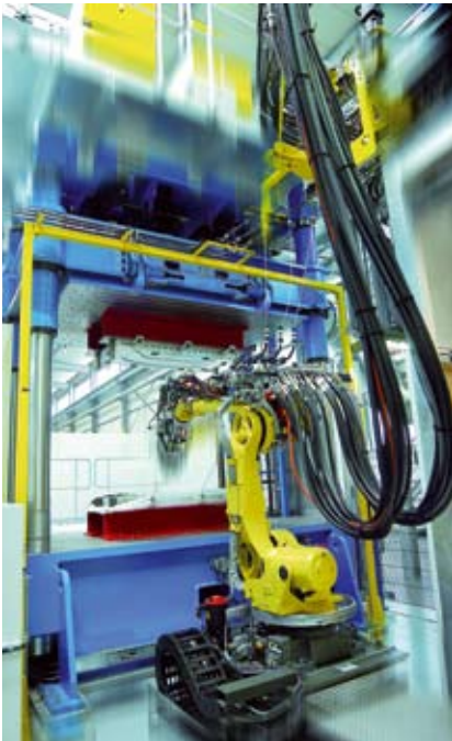
PUR-CSM-Anlage (Polyurethane Composite Spray Moulding) der Hennecke GmbH
