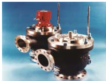
Seewasserventile für Nenndruck PN 63. Nennwerte 200, Gewicht ca. 150 kg. Werkstoff EBG=CuAl10Fe5Ni5-C.
