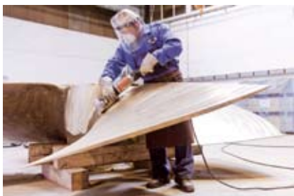
ZOLLERN-Mitarbeiter bei der Endbearbeitung eines Festpropellers für die Positionierung von Offshoreanlagen (Gewicht ca. 3.500 kg, Werkstoff: EBG = CuAl10Fe5Ni5)
