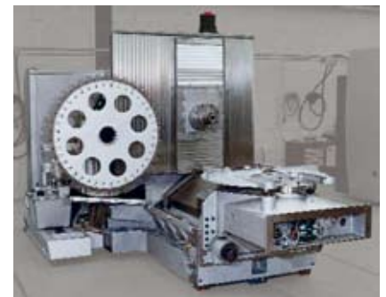
Bearbeitungszentrum von Hüller Hille / Heidenreich & Harbeck als RPT-Modell und fertige Anlage
