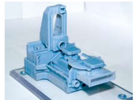
RPT-Modell eines Füllers und fertiges Produkt von rotring
